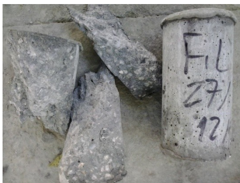
Figura 29: CP de CAA 27% antes e após ruptura.
