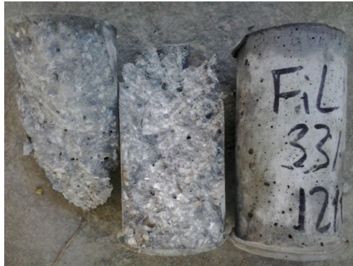
Figura 31: CP de CAA 33% antes e após ruptura.
