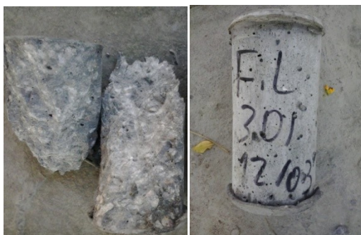
Figura 30: CP de CAA 30% antes e após ruptura.
