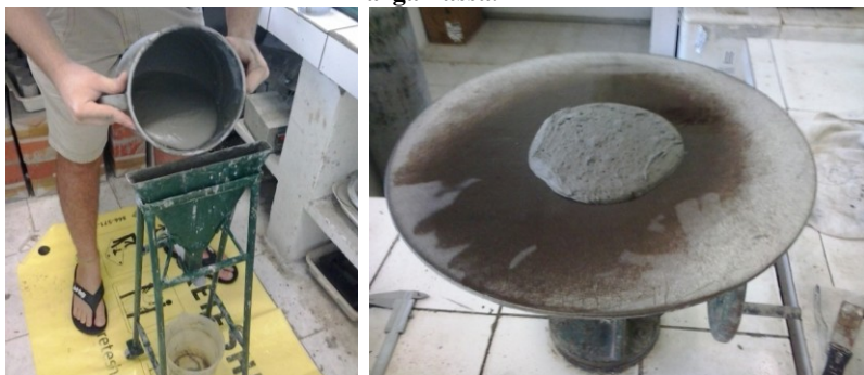
Figura 22: Ensaio de Funil V (esquerda) e espalhamento (direita) para argamassa.
