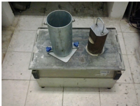
Figura 15: Equipamentos para ensaio de compressão+ vibração
