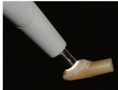
Figuras 14 e 15 - Aferição da cor com o espectrofotômetro Vita Easy Shade, observando o ângulo para tomada de cor durante o estudo.
