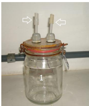
Figura 5: Exemplo do pote utilizado para realização do experimento (1), as setas indicam o meio pelo qual a água do mar, acidificada ou não, entrava e/ou saía por eles.
