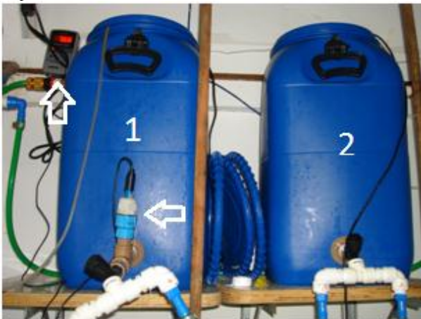
Figura 3: Galões de armazenamento dos meios circulantes de água do mar. As setas indicam o medidor de pH e o sensor acoplado a saída de água do meio acidificado. Os números indicam os galões acidificado com \text{CO}_2 (1) e o não acidificado (2).
