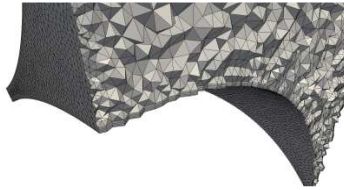
Figura 4.24 – Malha gerada em 826.552 células do arranjo de esferas em bloco hexagonal.
