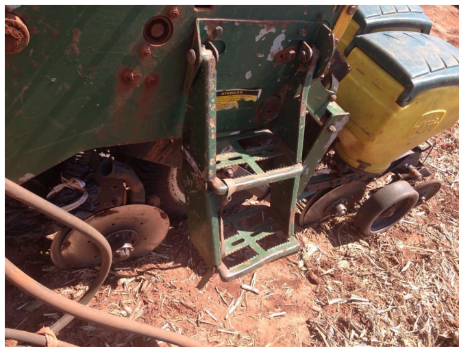
Figura 7. Regulagem da dosagem de adubo para semeadura da soja.
