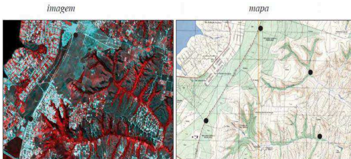
Figura 10: Georreferenciamento de uma imagem a partir de pontos de controle de um mapa georreferenciado. Fonte: IFSC (2010).
