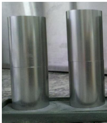
Figura 10 - Forma de posicionamento das peças para posterior processo de sinterbonding. Amostras posicionadas através de suas faces de topo.
