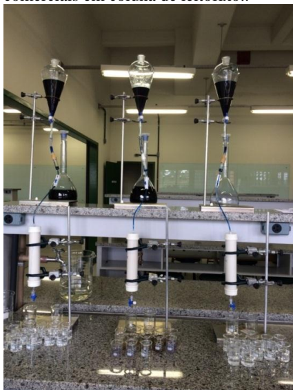
Figura 35 - Fotografia do experimento de degradação do corante pelas nZVI comerciais em coluna de leito fixo..
