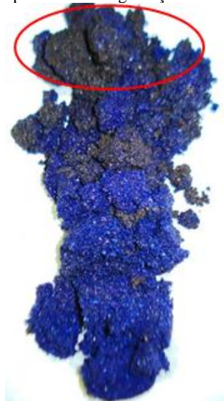
Figura 40 – Fotografia do interior da coluna com 0,64 % de nZVI comerciais, após teste de degradação.
