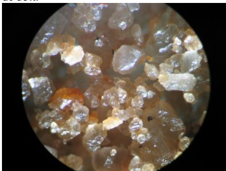
Figura 23–Análise de estrutura da areia por estereoscópio da areia: aproximação de 35x.
