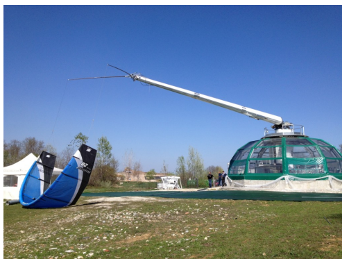
Figura 7 – Aerofólio flexível cabeado em modo de sustentação na configuração Yoyo , com atuadores no solo, e 2 cabos de tração/comando, da empresa italiana KiteGen .
