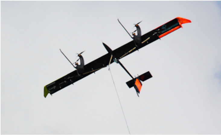
Figura 10 – Aerofólio cabeado em modo de arrasto, da empresa norte americana Makani Power .
