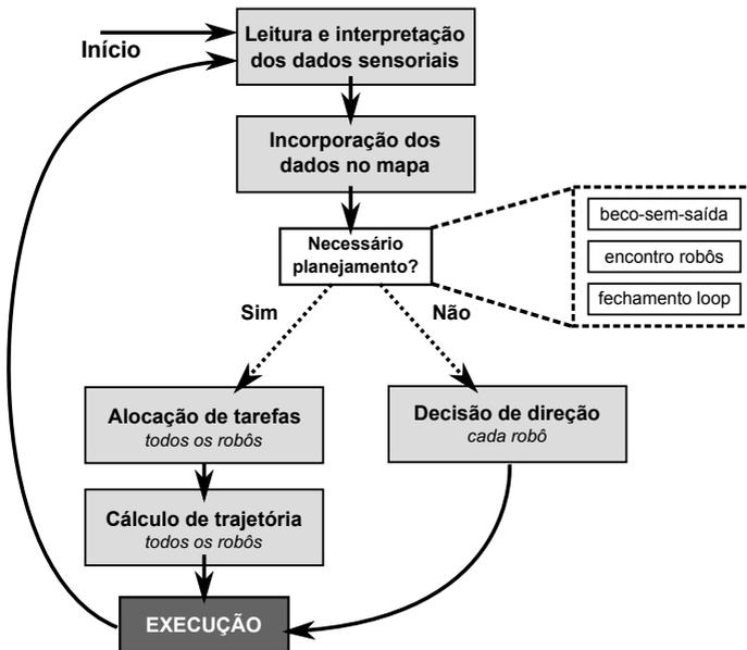
Figura 15: Fluxograma do processo de exploração proposto
