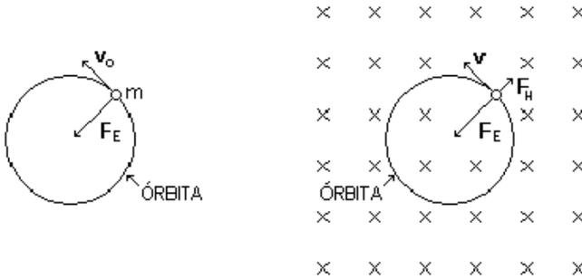
Figura 1 – Elétron descrevendo uma trajetória fechada ao redor do núcleo atômico. Um campo magnético externo irá provocar uma variação na velocidade deste elétron alterando, assim, o momento de dipolo magnético do átomo.
