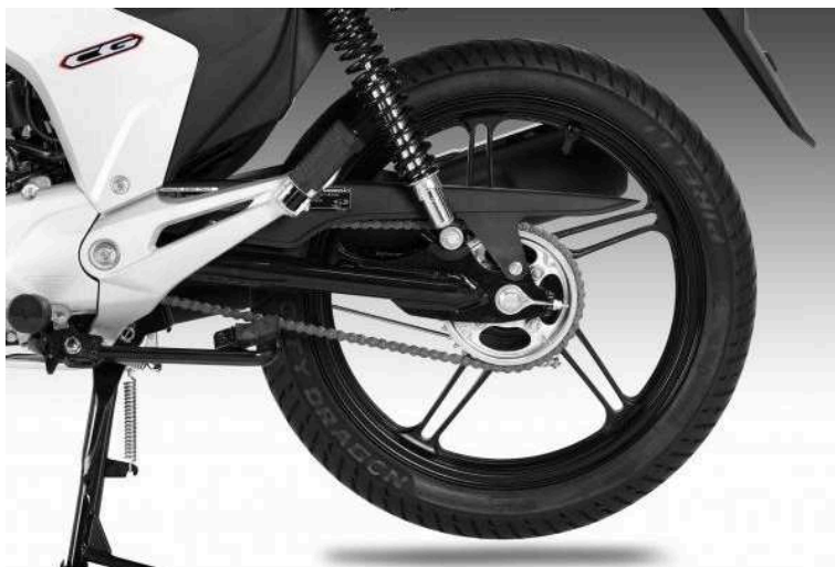
Figura 2 - Conjunto de suspensão traseira a ser estudado, modelo Honda CG 125.
