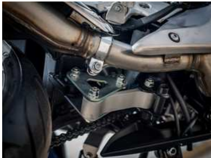
Figura 13 – Sistema de fixação da suspensão por links
