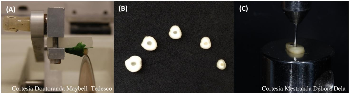
**Figura 3.** Corte dos espécimes e teste de *push out*. (A) Corte dos dentes na máquina IsoMet 1000. (B) Fatias obtidas no corte. (C) Teste de *push out* na máquina de ensaios mecânicos.
