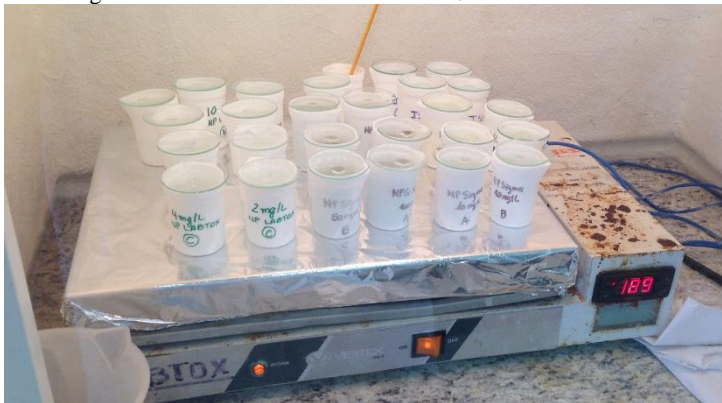
Figura 7 – Digestão ácida das amostras de NP \text{Cr}_2\text{O}_3
