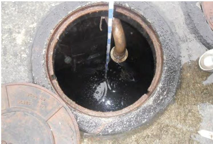
**Figura 13** Medições do nível de esgoto dentro do último compartimento do RAC
