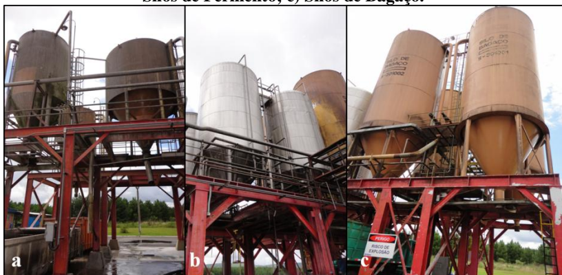
Figura 12: Área de silos de subprodutos. a) Silos de Terra Infusória; b) Silos de Fermento; c) Silos de Bagaço.
