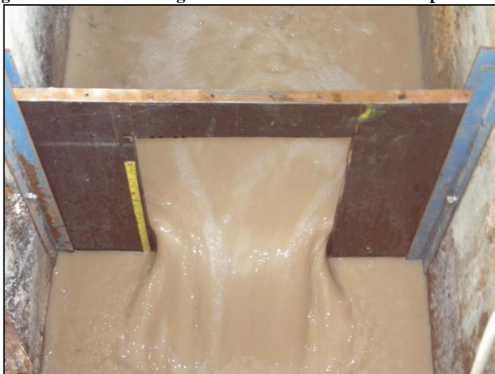
Figura 7: Vertedor retangular em funcionamento. Visão aproximada.
