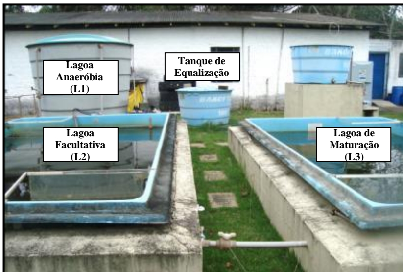
Figura 7 - Vista geral do sistema de lagoas de estabilização para tratamento de lixiviado de aterro do Laboratório Experimental de Resíduos Sólidos da UFSC.
