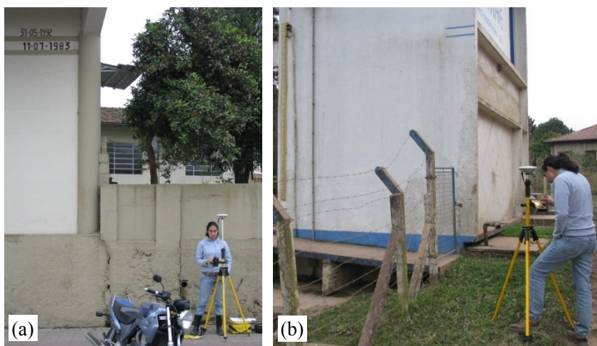
Figura 7 – Levantamento em campo dos marcos das inundações de 83 e 92; (a) na igreja de Santo Antônio de Pádua e (b) na captação de água do SAMAERN.
