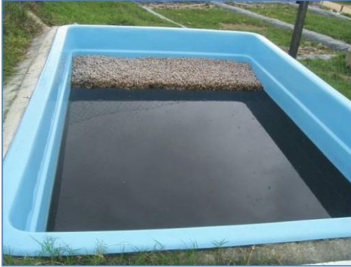
Figura 6: Lagoa-filtro para o polimento de dejetos suínos
