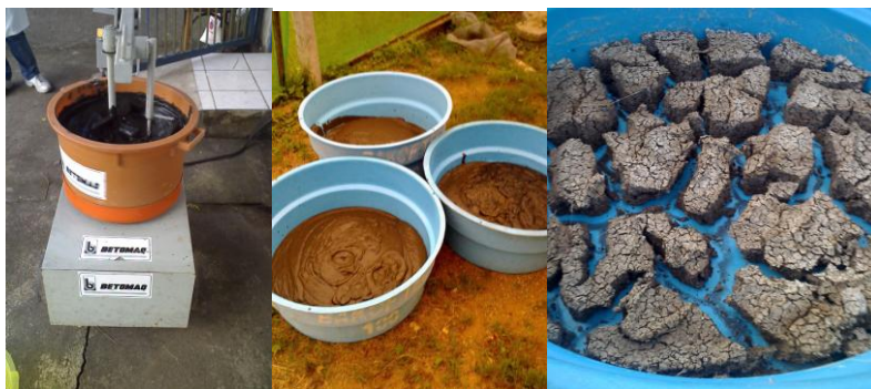
Figura 6 - Processo de mistura dos materiais, calagem, armazenagem e maturação.
