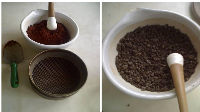
Figura 8 - Preparação da Amostra de lodo Estabilizado (AE15) e do Solo Natural
