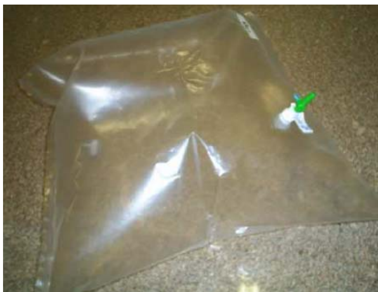
Figura 3.1 – Sacos plásticos tedlar usado para amostragem
