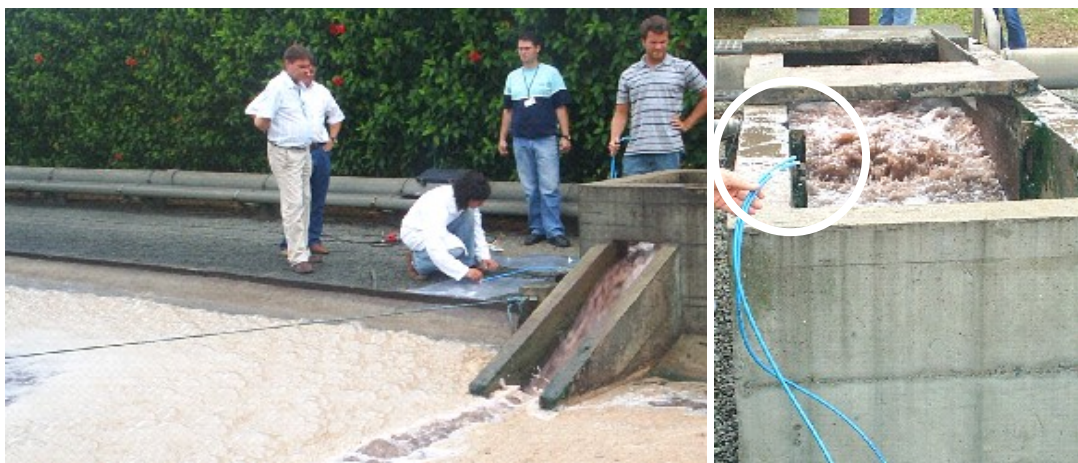
Figura 4.10: Amostragem no ponto 8 – Tanque aerado (entrada do efluente)
