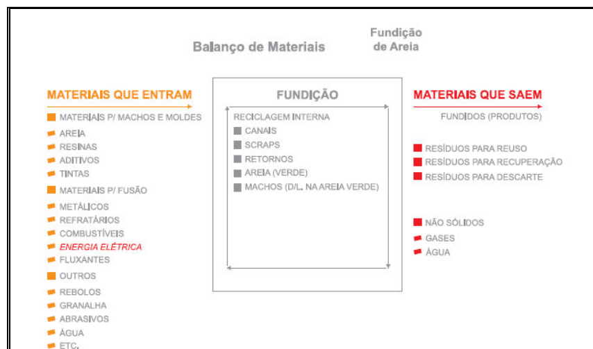
Figura 2- Exemplo de balanço de massa do processo de fundição. FONTE: ALVAREZ (2001)
