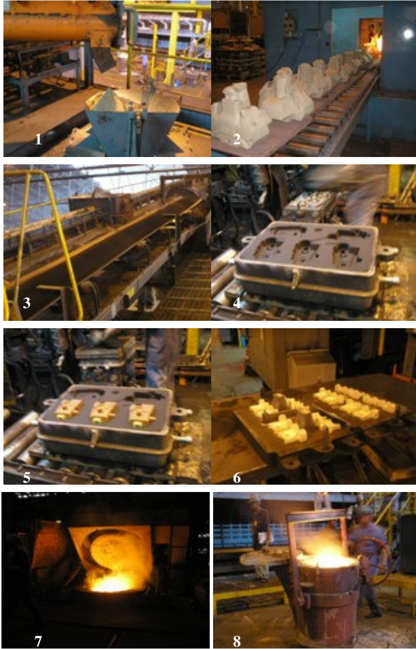
Figura 10- (1) Areia de Macharia (2) Machos (3) Areia de Moldagem (4) Moldes (5) Molde com machos (6) Modelo (7) Forno (8) Panela
