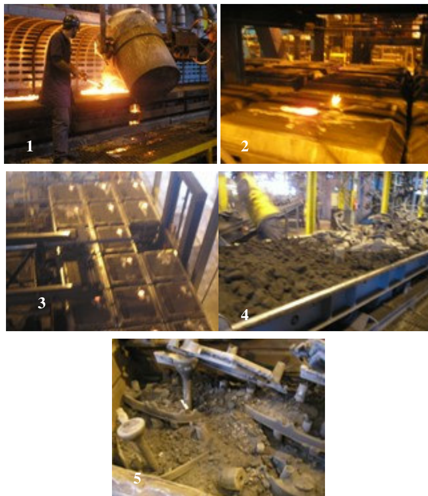
Figura 11 - (1) Vazamento (2) Resfriamento (3) Resfriamento (4) Esteira Vibratória de Desmoldagem (5) Quebra de Canal.
