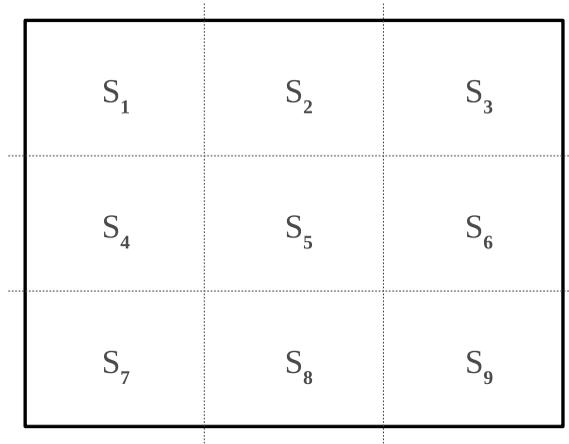
Figura 26: Representação das 9 seções em que a imagem é dividida para considerar o modelo heterogêneo de correção da distorção da lente.
