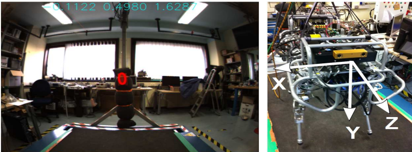
Figura 6.7: À esquerda, imagem do sistema de visão do robô com o alvo rastreado ao centro. À direita, imagem da câmera do sistema de visão e do posicionamento do robô sobre a esteira. Obs: o sistema de coordenadas visto na figura à direita é o sistema de coordenadas da câmera.
