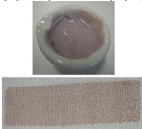
O efeito do aumento da quantidade de tensoativo CTAB (ensaios (2), (3), (5), (6), (8), e (9)) resultam em suspensão estável, mas ocasionou a diminuição da viscosidade da pasta, e problemas de solubilidade do CTAB, ocasionando manchas nas estampas pela obstrução dos poros da tela.
