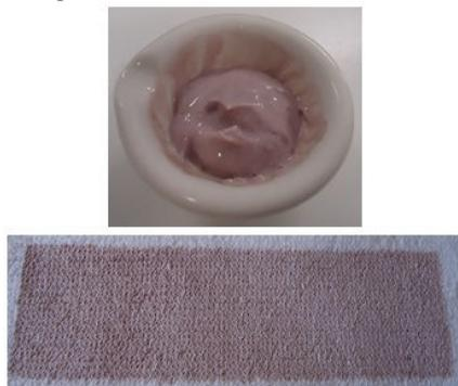
Os resultados obtidos no ensaio (4), utilizando a relação mássica de 0,3 % de tensoativo aniônico 1 (TA1) sobre a argila, não foi suficiente para sua dispersão, resultando em uma pasta cheia de aglomerados de argila.
