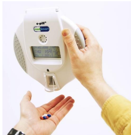
Figura 20 - Mecanismo de retirar os comprimidos do MedSmart [52].
