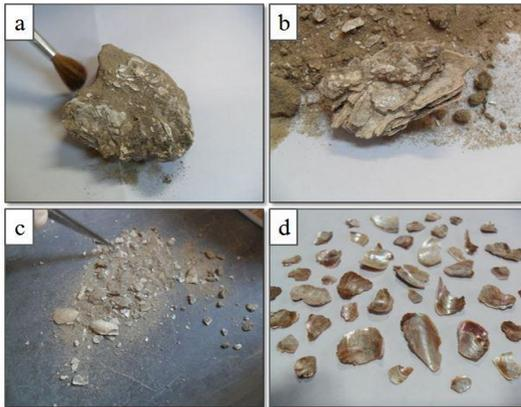
Figura 2 - Coleta do material malacológico. Legenda: a- bloco coletado em sua condição original de compactação; b – bloco de conchas de *Perna perna* fragmentadas parcialmente separado; c – conchas em estágio avançado de separação; d – conchas selecionadas e pré-tratadas.
