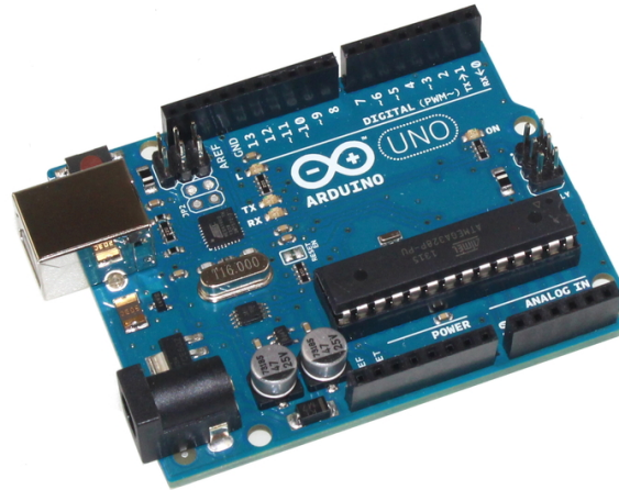
Figura 2.1: Placa do Arduino Uno. Fonte: https://www.robocore.net
