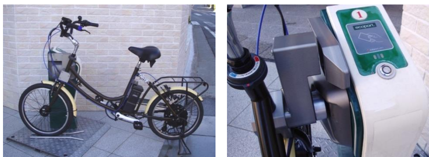
Figura 1.11 - Posto de carregamento indutivo ressonante [36]
