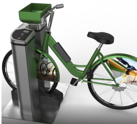
Figura 1.7 - Sistema de carregamento indutivo ressonante aplicado a E-bike [20].
