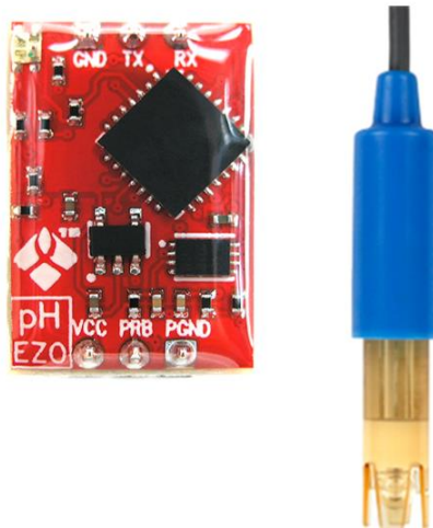
Figura 5.3 Componentes responsáveis pela medição de pH. À esquerda o circuito EZO e à direita o sensor potenciométrico.
