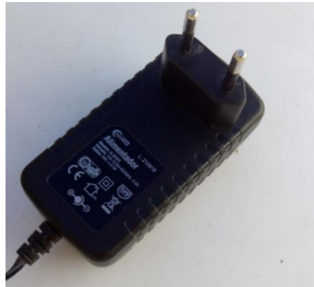
Figura 4.14 - Adaptador AC/DC 48 V para os ventiladores do armário
