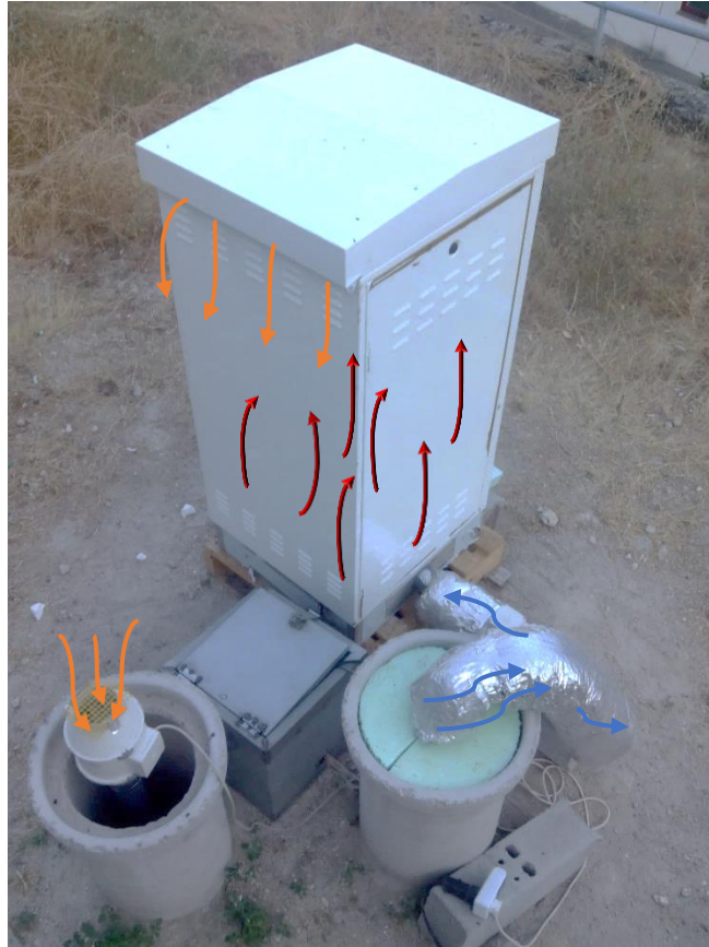
Figura 5.7 - Esquema de montagem do ensaio com o permutador de calor ar-solo
