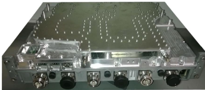
Figura 2.14 - Unidade de radiotransmissão com permutador ar-água. Nörtershäuser et al. , (2014)
