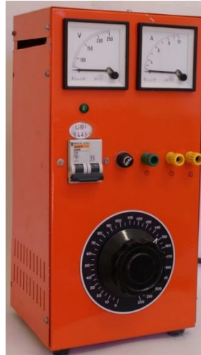
Figura 4.12 - Fonte de alimentação AC variável presente no laboratório
