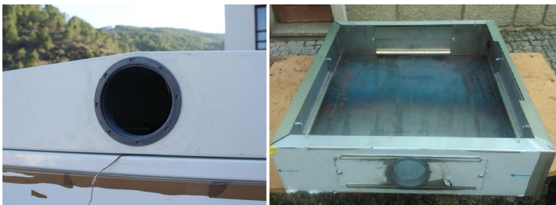
Figura 4.4 - Fotografias da intervenção ocorrida no topo e na base do armário necessárias para os ensaios
