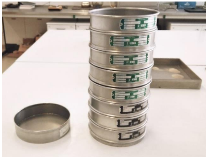
Figura 3.16 - Peneiras usadas para separar o material retirado dos furos. Calado, (2016)
