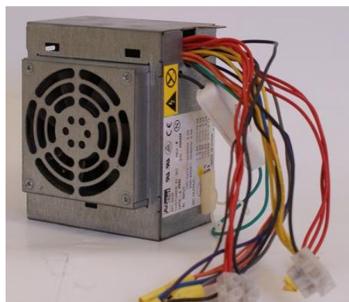
Figura 4.13 - Fonte de alimentação DC de valor fixo
