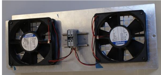
Figura 4.9 - Ventiladores EBM-PAPST presentes no interior do armário
