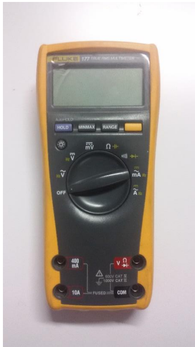
Figura 4.15 - Multímetro digital Fluke, modelo 177.
