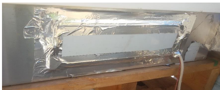
Figura 4.27 - Zona do pedestal isolada.
