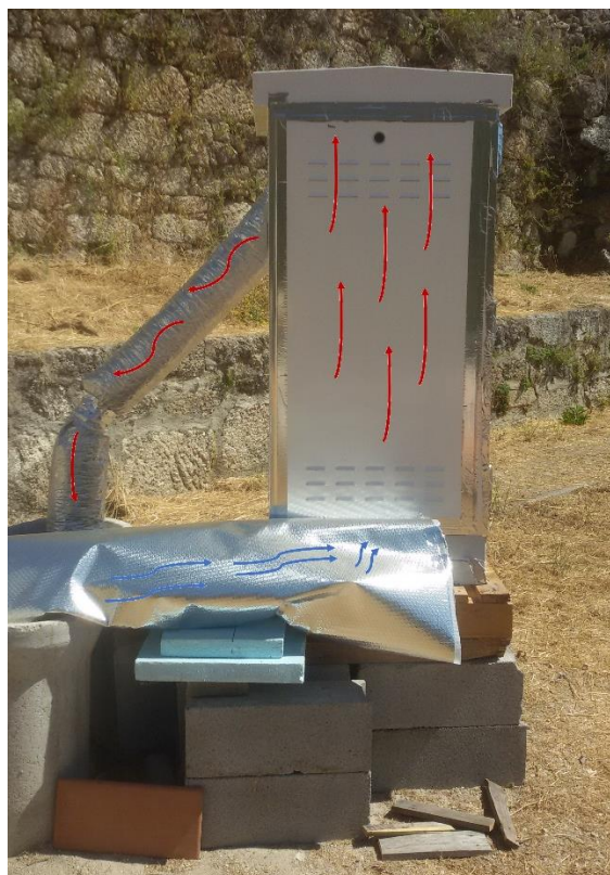
Figura 4.29 - Esquema do fluxo de ar no sistema ensaiado.
