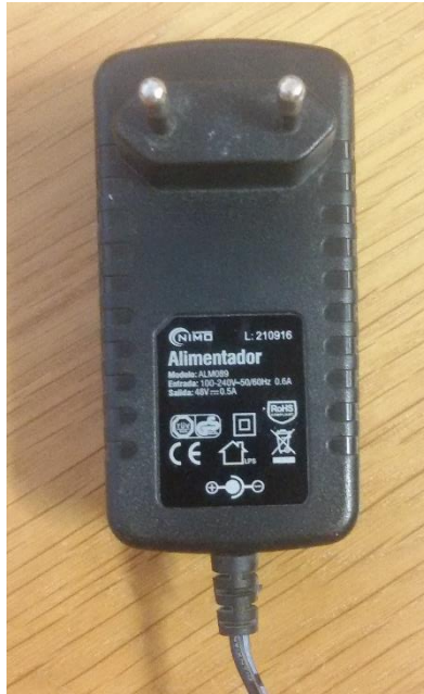
Figura 4.18 - Transformador AC/DC 48 V.
