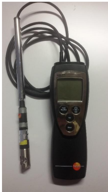
Figura 4.7 - Anemómetro de hélice, modelo Testo 416.
