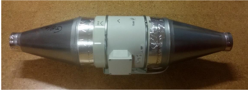
Figura 4.9 - Ventilador TD-800/200 da marca S&P.
