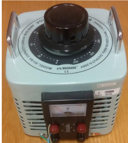
Figura 4.16 - Fonte de alimentação AC variável, modelo SV-8A.
