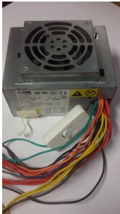
Figura 4.17 - Fonte de alimentação dos ventiladores da caixa dissipadora de calor.
