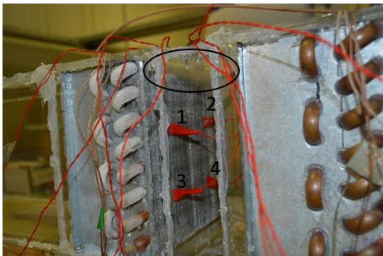
Figura 30. Superfície frontal do evaporador no momento em que o sensor 2 deteta formação de gelo.
