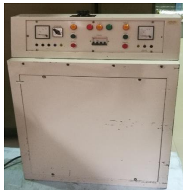
Figura 18. Fonte de tensão utilizada para controlo da humidade relativa do ar durante os ensaios experimentais (Dias, 2017).
