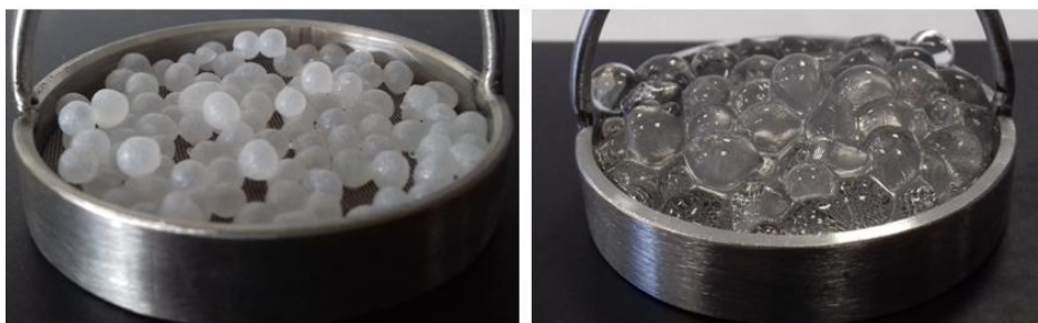
Figura 4.34 - DDS antes (esquerda) e após (direita) dos estudos cinéticos de liberação do Diclofenac.
