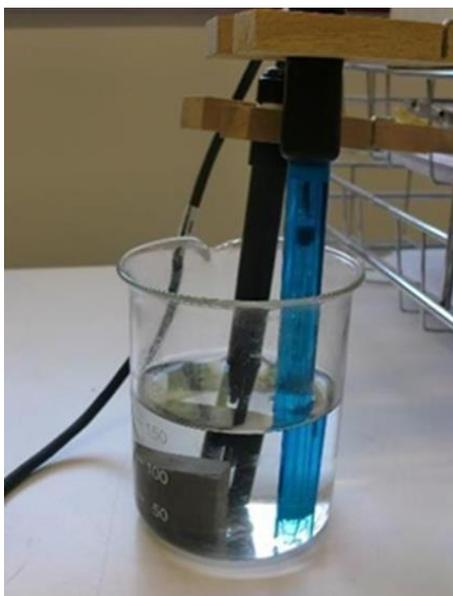
Figura 3. 5 Imagem das sondas de condutividade e pH durante as medições dos lixiviados de uma das misturas.
