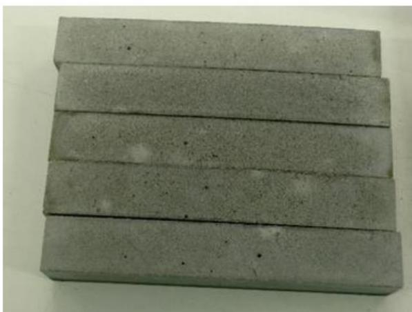
Figura 3. 4 Exemplo de provetes após desmoldagem (neste caso GEO80L-10V-10MTC-10M)
