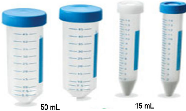
Figura 2 - Tubos Falcon para limpeza da amostra com método QuEChERS.
