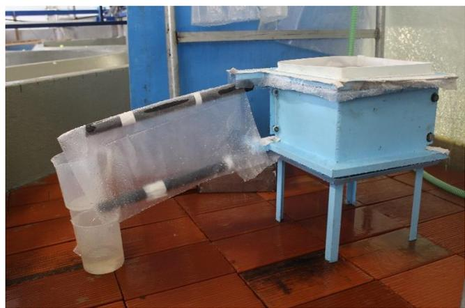
Molde desenvolvido para ensaio de infiltração
