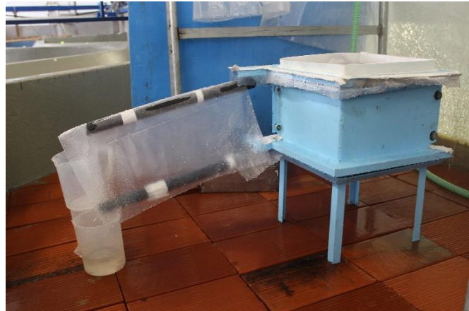
Molde desenvolvido para ensaio de infiltração
