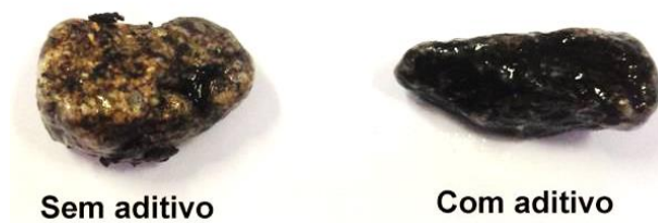
Figura 3. Aspeto de agregados após ensaio de afinidade agregado/betume
