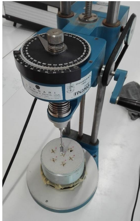
Figura 3.2 - Aparelho do Vane após a realização do ensaio
