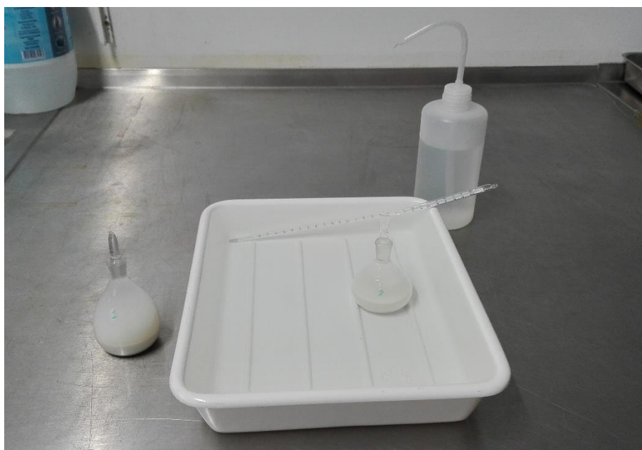
Figura A2. 1 - Determinação da massa volúmica das partículas pelo Método do picnómetro líquido
