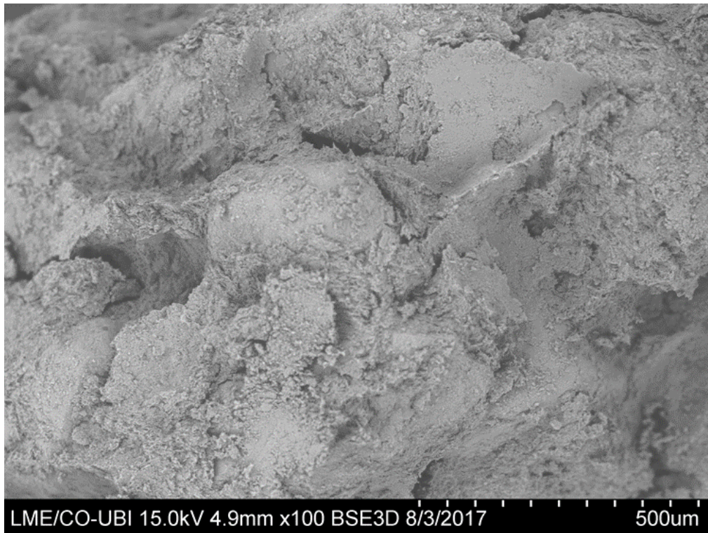
Figura 4.1 - Imagem ampliada 100x do solo seco (0% biopolímero)
