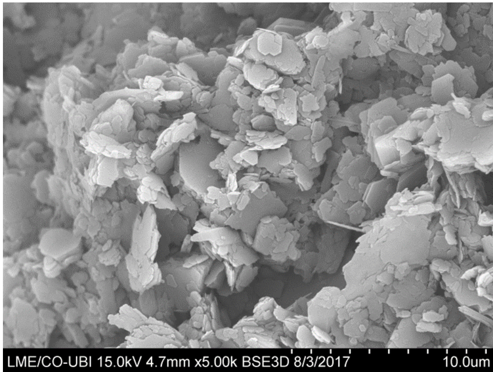
Figura 4.4 - Imagem ampliada 5000x do solo seco (0% biopolímero)
