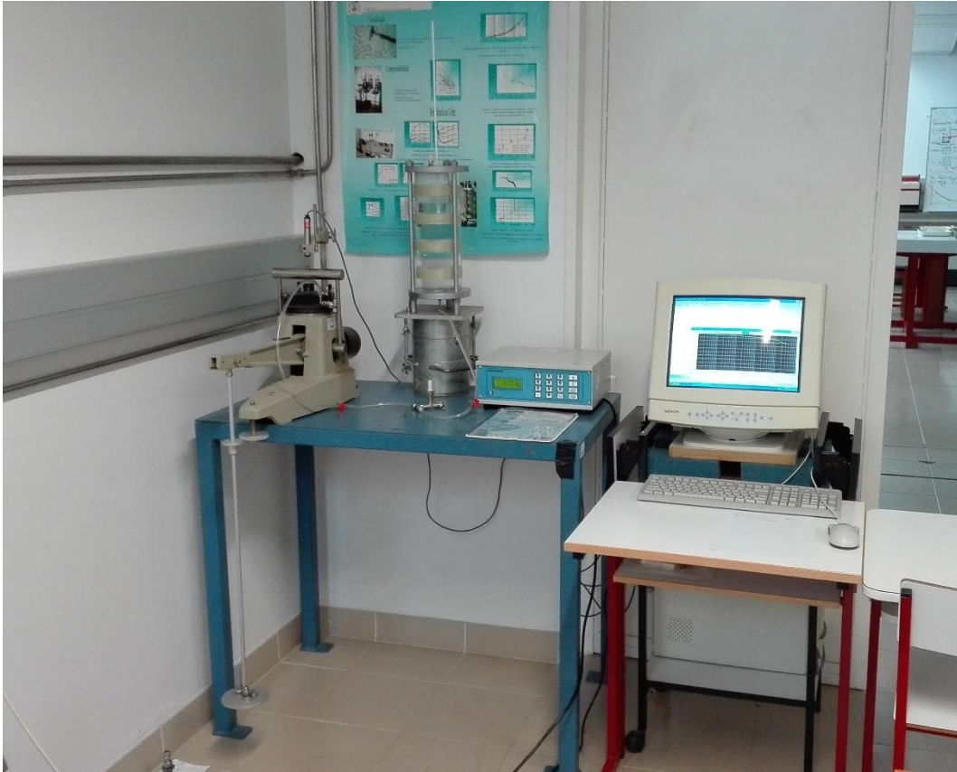
Figura 3.3 - Vista geral do edômetro de permeabilidade durante a realização do ensaio
