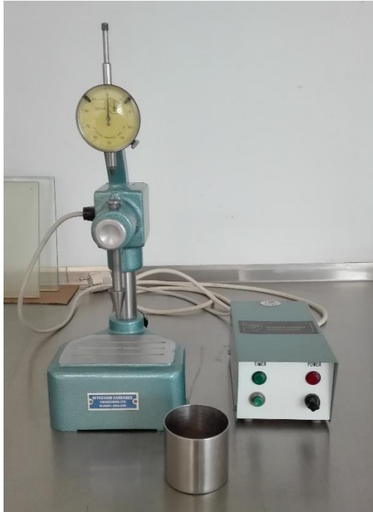
Figura 3.1 - Aparelho do Cone Penetrômetro automatizado
