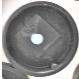
Figura 22 - Detetor CR39 fixado na tampa da câmara de difusão.
