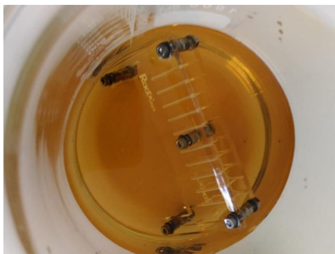
Figura 26 - Suporte com os detetores CR39 mergulhados na solução.
