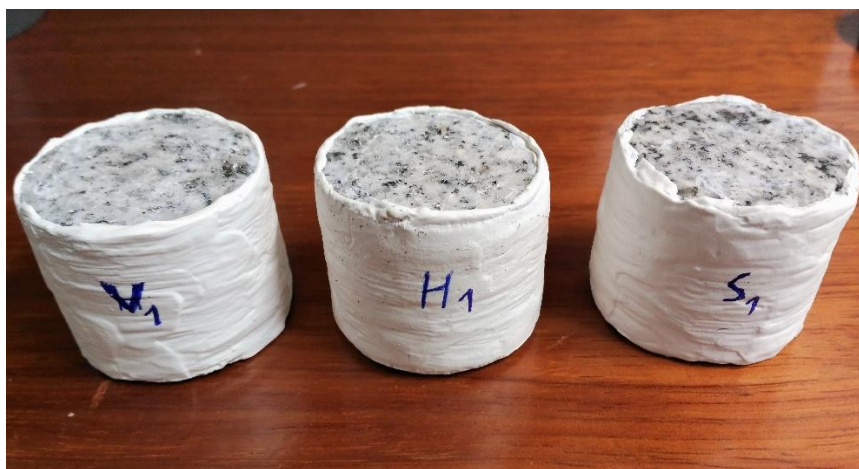
Figura 38 - Amostras impermeabilizadas lateralmente e devidamente identificadas.
