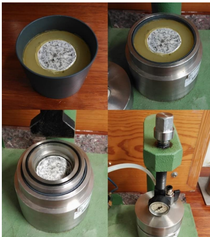
Figura 39 - Fases de preparação do ensaio de permeabilidade.
