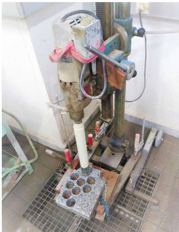
Figura 36 - Extração dos corpos de prova utilizando a caroteadora.
