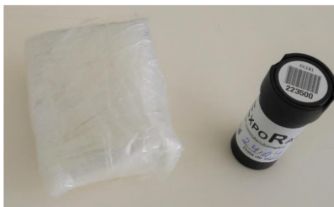
Figura 33- Detetor selado dentro da manga plástica e detetor livre.
