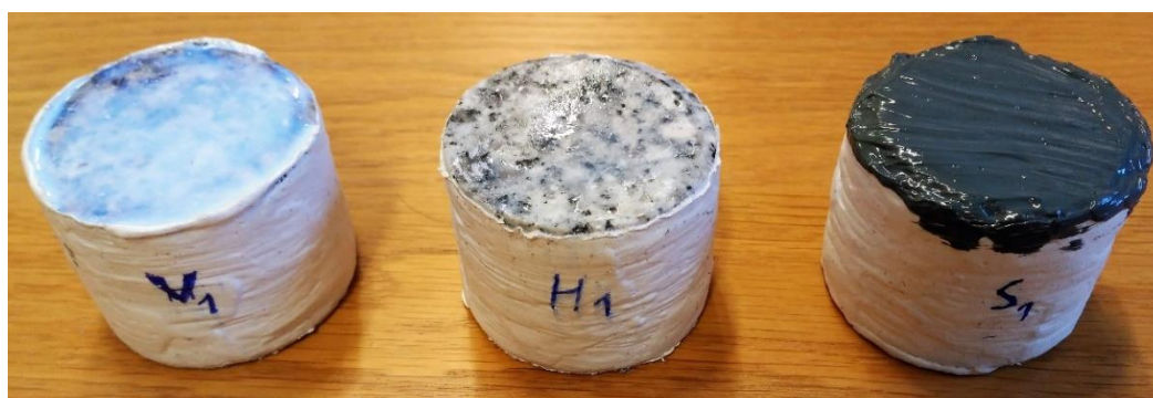
Figura 40 - Aplicação dos revestimentos nas amostras.
