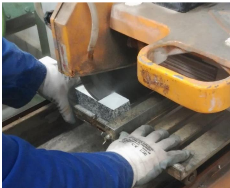
Figura 30 - Corte das amostras de granito.
