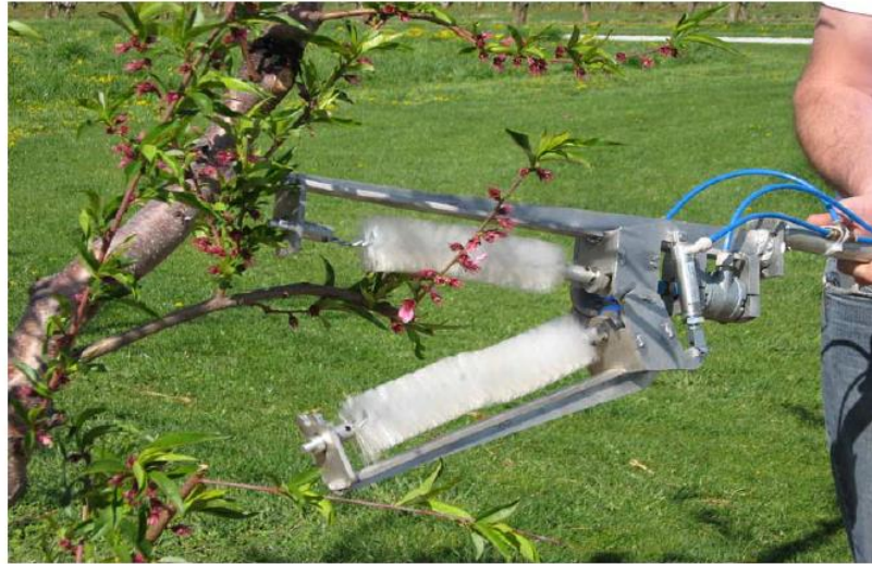
Figura 2.8 - Protótipo de uma garra para a monda da flor [20].
