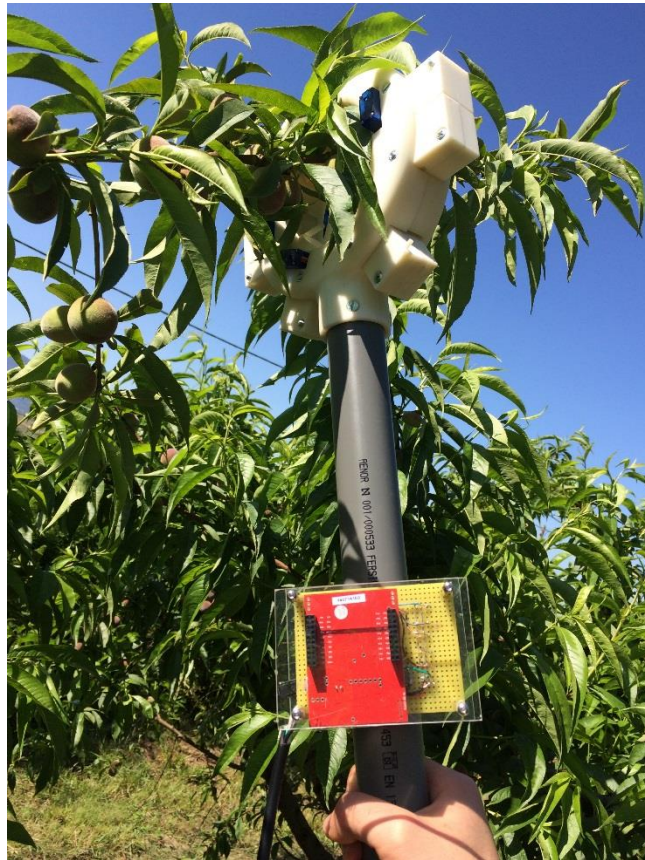
Figura 8.6 - Ensaio de força de atuação , verificação da geometria e ergonomia no campo.
