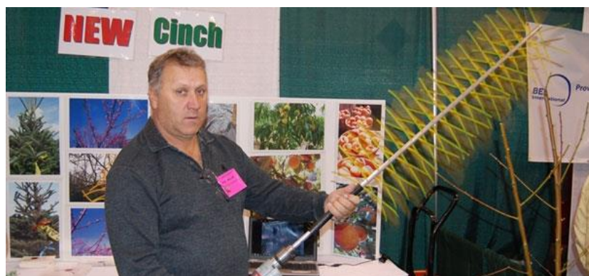
Figura 2.7 - Máquina para a monda da flor de pessegueiro Cinch, e o seu inventor ( http://fruitgrowersnews.com ).
