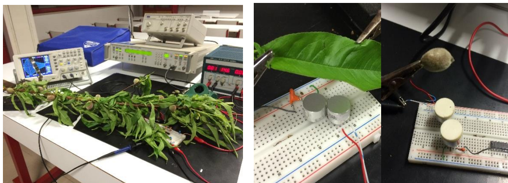
Figura 5.2 - Recolhas de ondas ultrassónicas refletidas a partir da periferia de ramos e em frutos e folhas isolados.
