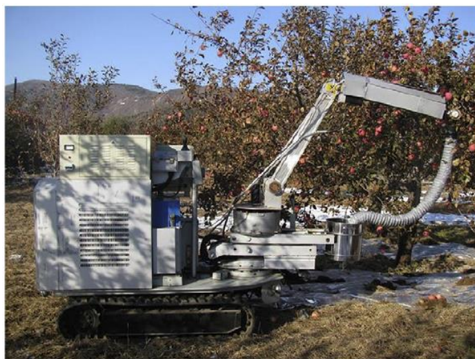
Figura 3.1 -Ensaio de campo de um sistema autónomo de colheita de frutos baseado num manipulador PRRRP [40].
