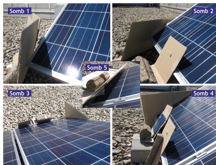
Figura 3.31 - Módulo PV em condições de irradiância não uniforme.
