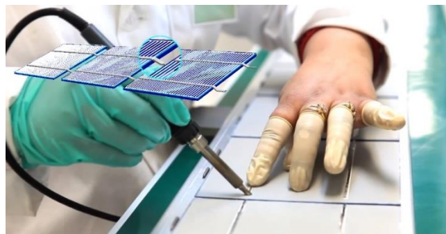
Figura 2.17 - Conexão em série de células PV cristalinas (Adaptado de [24]).
