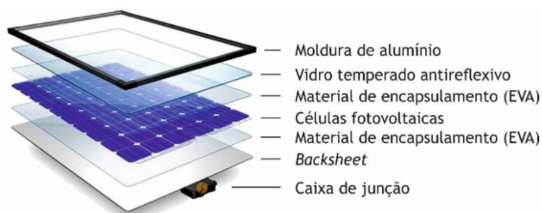
Figura 2.22 - Constituição de um módulo PV de silício cristalino [51].
