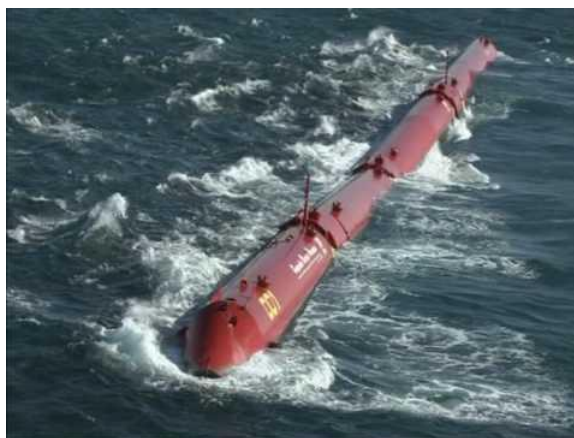
Figura 3.1 - Dispositivo PELAMIS em funcionamento no Parque de Ondas da Aguçadoura. Fonte: Ref. A.9.
