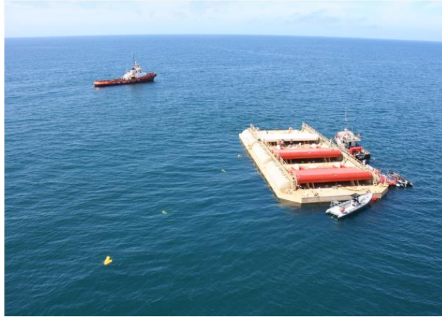
Figura 3.2 - Dispositivo WaveRoller a ser rebocado. Fonte: Ref. A.10.
