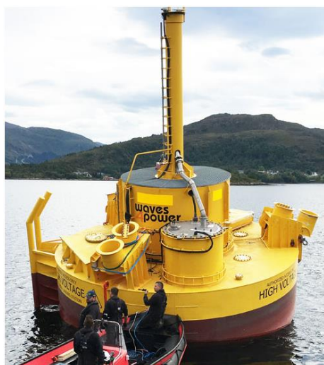
Figura 3.16 - Dispositivo waveEL no Parque de Ondas de Rundle, na Noruega. Fonte: Ref. A.23.
