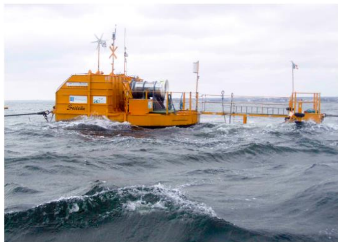
Figura 3.11 - Dispositivo OEBuoy à escala 1:4. Fonte: Ref. A.19.
