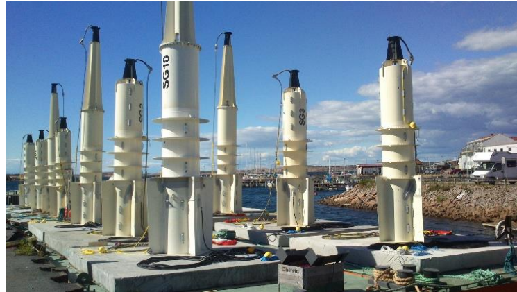
Figura 3.5 - Dispositivo Uppsala/Seabased AB Wave Energy Converter, aguardando instalação em Sotenäs. Fonte: Ref. A.13.
