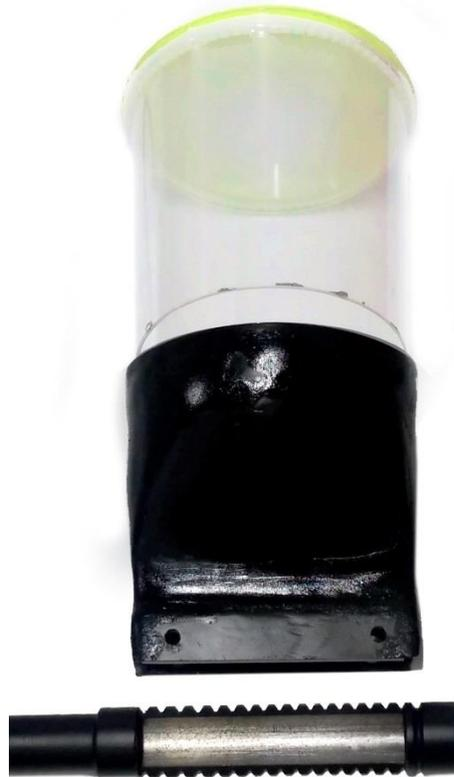
Figura 72. Zona de alimentação constituída pelo reservatório, funil e corte longitudinal.
