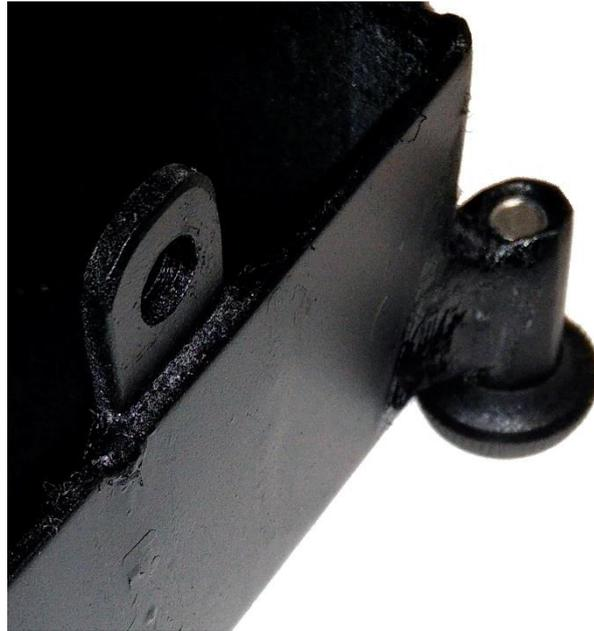
Figura 63. Sapata de ajuste e furo para conectar o tabuleiro à base de suporte da extrusora.
