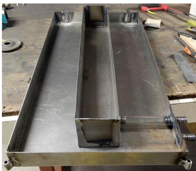
Figura 62. Tabuleiros após serem limadas as soldaduras, conectados entre si com tubo flexível.
