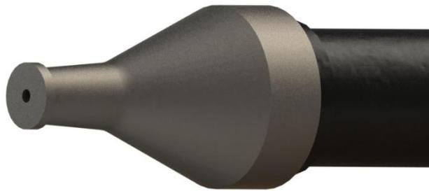
Figura 53. Desenho da cabeça de extrusão.
