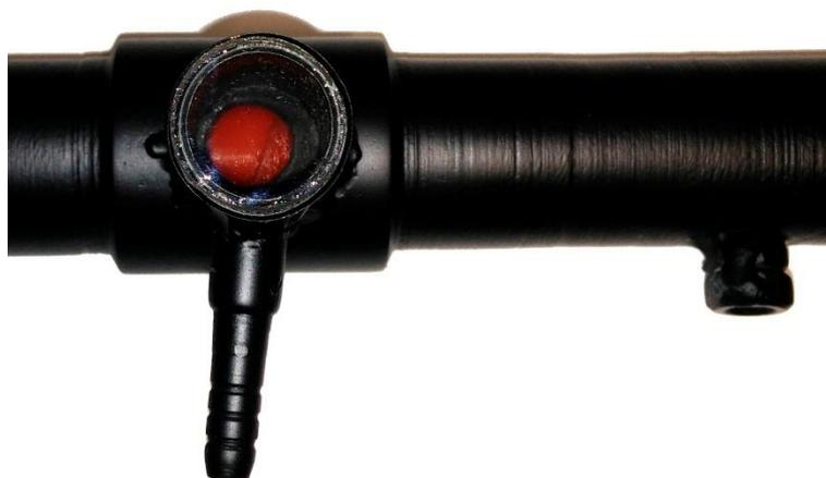
Figura 67. Tomada de vácuo com vista para o interior e encaixe para um termopar.
