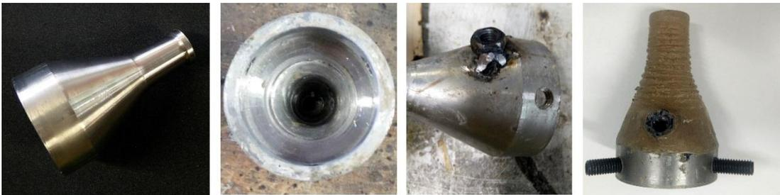
Figura 78. Processo de fabrico da cabeça.
