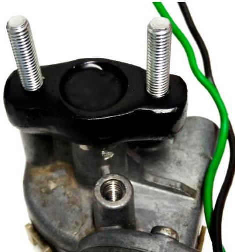
Figura 73. Conexão cravada no motor para apertar na roda dentada.
