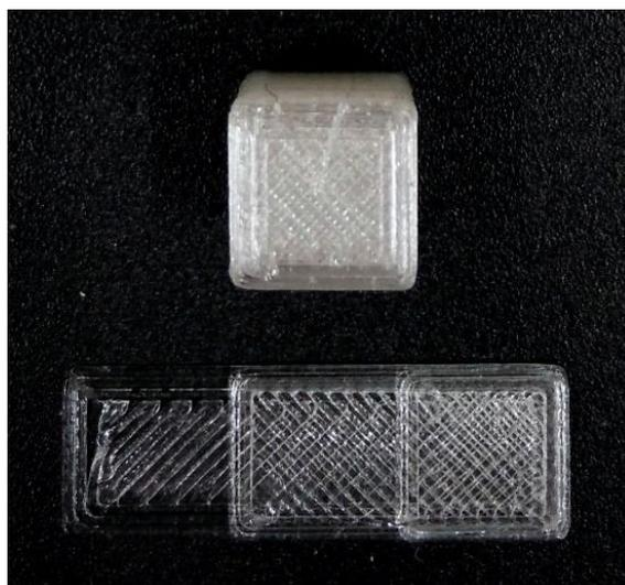
Figura 36. Cubo e lamela impressos em PET numa máquina de FDM.
