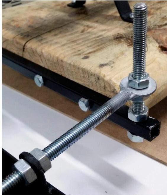
Figura 64. Sistema de encaixe entre a base e o reservatório de refrigeração.
