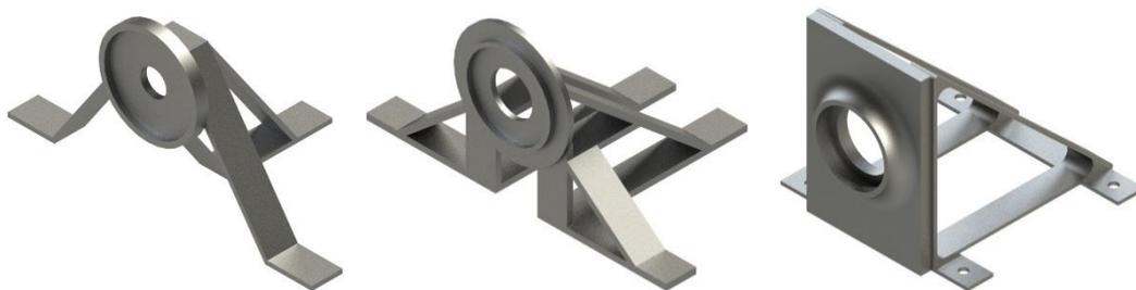
Figura 47. Evolução do desenho do suporte da chumaceira como exemplo do processo iterativo do desenho da máquina.
