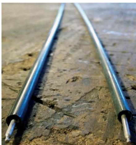
Figura 68. Resistências de 500 W isoladas eletricamente.
