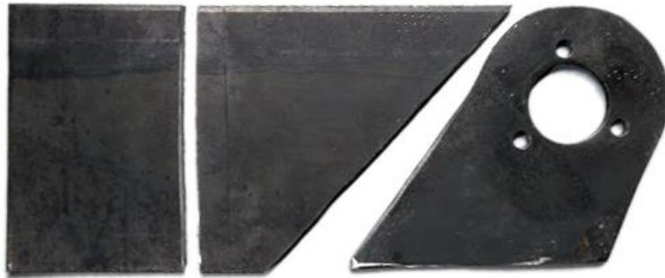
Figura 74. Primeiros passos para a construção do suporte do motor.
