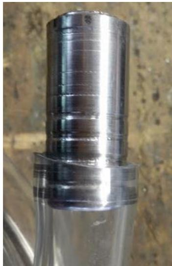
Figura 61. Adaptador para soldar aos reservatórios e ligar ao tubo flexível.
