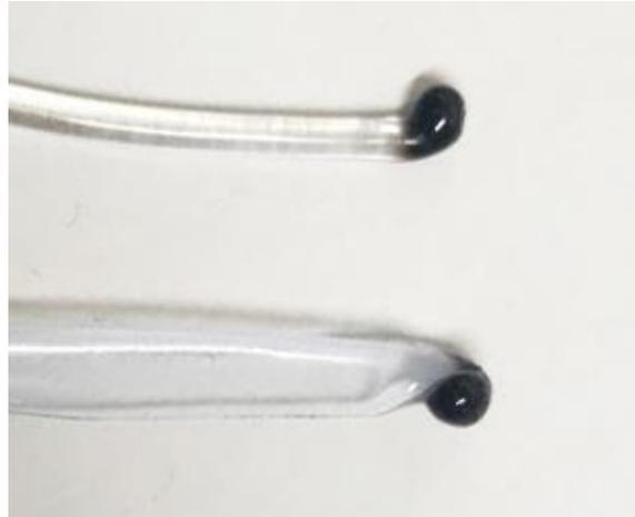
Figura 35. Resultado da queima de filamento PET (em cima) e um bocado de uma garrafa constituída por PET (em baixo).
