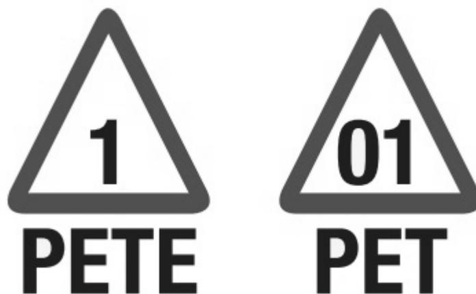
Figura 1. Código de identificação da resina opção A e opção B (ASTM D7611 / D7611M, 2013).
