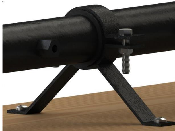
Figura 51. Desenho da peça de fixação da camisa.
