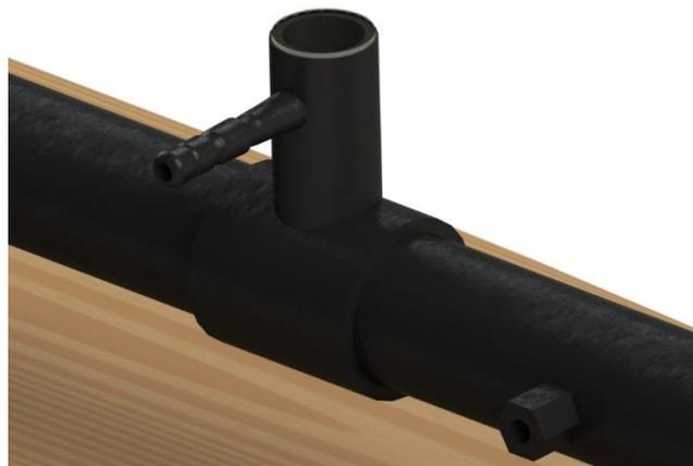
Figura 52. Desenho da tomada de vácuo na camisa e encaixe do termopar.
