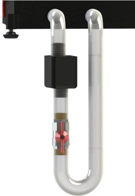
Figura 56. Desenho do circuito de refrigeração ligado numa configuração tomada de saída → torneira → bomba de água → tomada de entrada.
