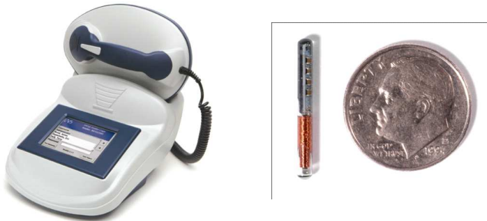
Figura 2.8: Dose Verification System (DVS) da Sichel Technologies. Detalhe do aparelho de leitura e do dosímetro implantável.
