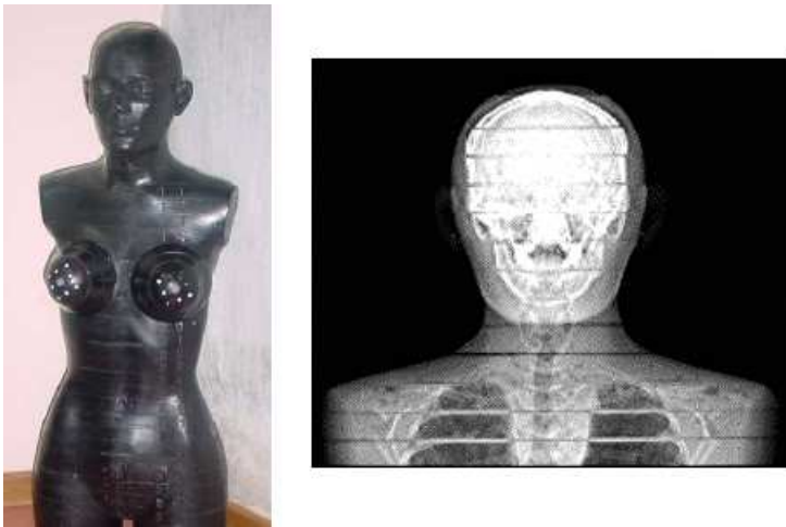
Figura 1.3: Foto (figura à esquerda) e tomografia (figura à direita) do simulador antropomórfico feminino (RANDO Alderson). Figura extraída de [7].
