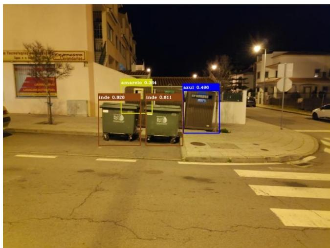
Figura 5. Demonstração de deteção de contentores no período noturno.
