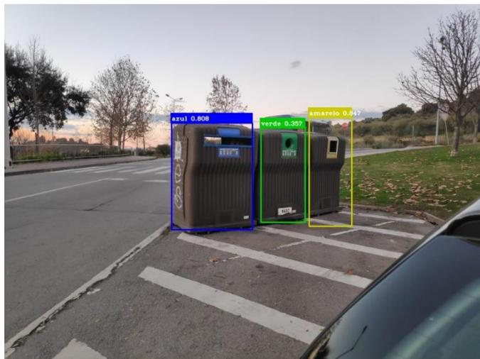
Figura 4. Demonstração de deteção de contentores no período diurno.
