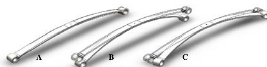
Figura 2 – Deformações comuns no processo de fabrico de molas de lâmina, como a torção (A), o camber (B) e a curvatura longitudinal (C).
