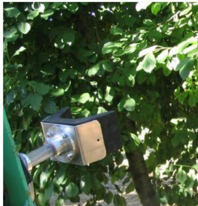
Fig. 1 - Máquina vibratória de monda do pêsegueiro sem acoplamento mecânico ao ramo (Rosa et al. [4]).
