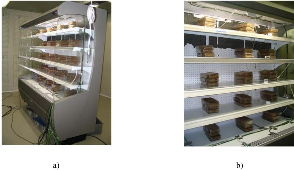
Figura 2. Disposição genérica dos simuladores de produtos e das pontas de prova: termopares, anemómetros e higrómetros.
